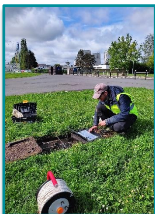
Contrôle du niveau mesuré par le piézomètre du CD77 de Roissy-en-Brie le 6 mai
